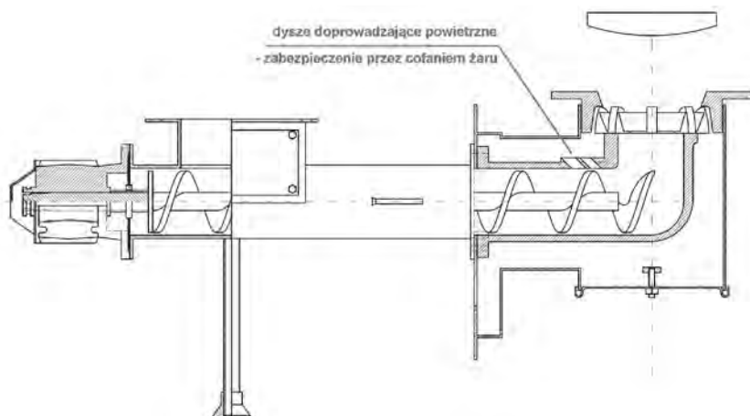
Rysunek 10 Retorta z dyszami powietrznymi zabezpieczającymi przez cofaniem żaru.
