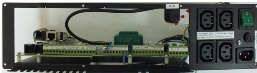
Rysunek 1 Listwa przyłączeniowa do zasilania urządzeń regulacyjnych
