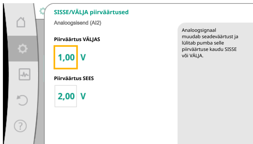
Fig. 74: SISSE/VÄLJA juhtimise piirväärtused analoogsignaali kaudu
