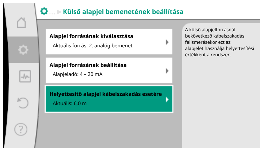
Fig. 77: Helyettesítő alapjel kábelszakadás esetére
