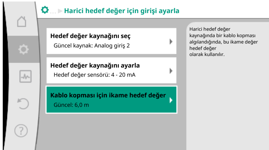
Fig. 77: Kablo kopması için ikame hedef değer
