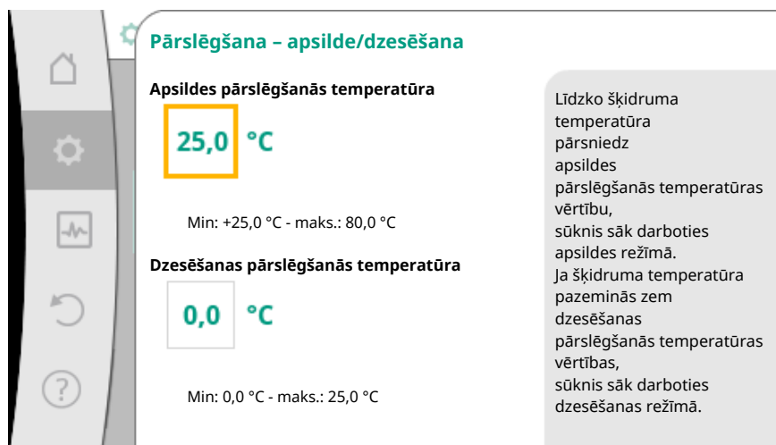
Fig. 57: Pārslēgšana – apsilde/dzesēšana_Pārslēgšanas temperatūra
