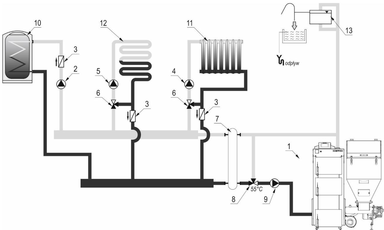
Rysunek 9. Uproszczony schemat instalacji grzewczej systemu otwartego.
