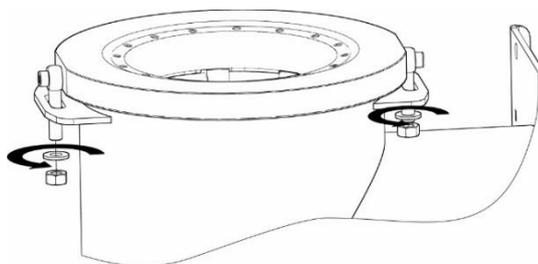
KROK 1. Odkręcić nakrętki mocujące płytę palnika retortowego.
