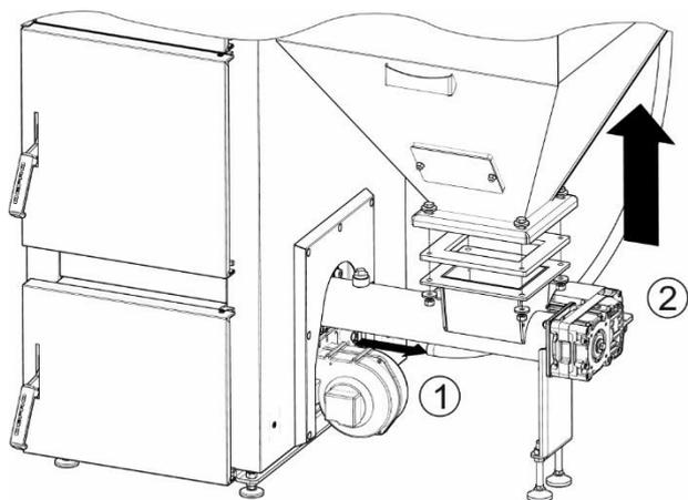
KROK 1. Odłączyć wąż systemu wyrównania ciśnienia od płyty podajnika, a następnie odkręcić nakrętki mocujące, zdemontować zasobnik paliwa oraz uszczelkę. Sprawdzić stan uszczelki, w razie konieczności wymienić.
