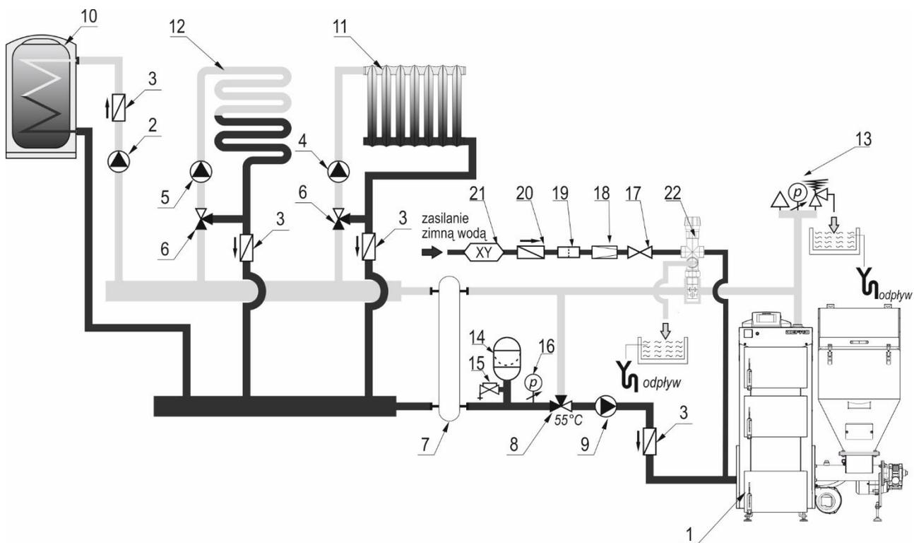
Rysunek 10. Uproszczony schemat instalacji grzewczej systemu zamkniętego.
