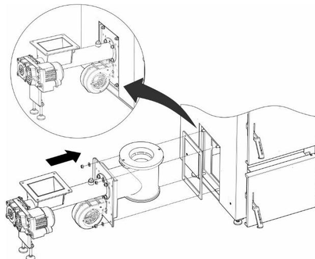
KROK 6. Zamontować uszczelkę palnika, a następnie przykręcić palnik do korpusu kotła.
