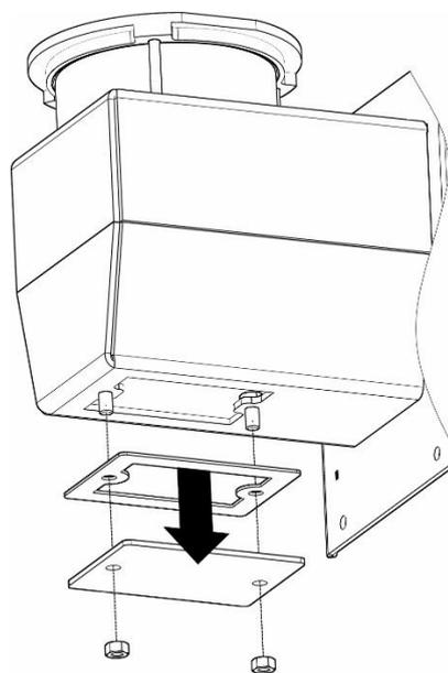
Odkręcić nakrętki mocujące pokrywę wyczystki palnika retortowego, czyścić korpus palnika, sprawdzić stan uszczelki, następnie zamontować szczelnie pokrywę wyczystki.
