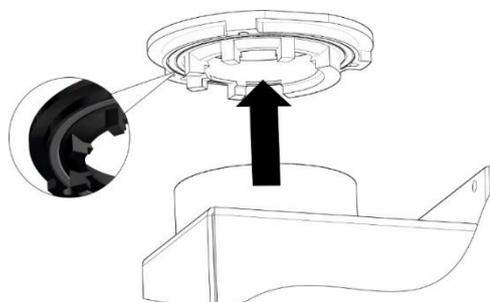
KROK 2. Zdemontować płytę palnika retortowego, sprawdzić stan sznura uszczelniającego.
