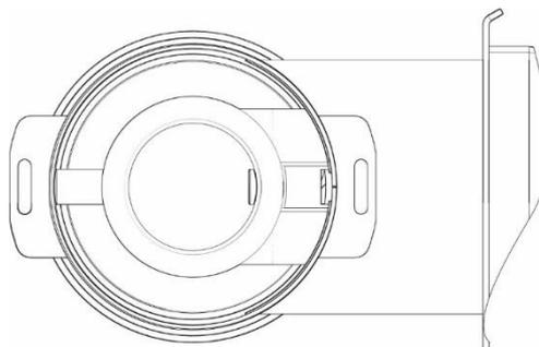
KROK 4. Widok na palnik ze zdemontowaną płytą paleniska oraz koroną palnika retortowego.
