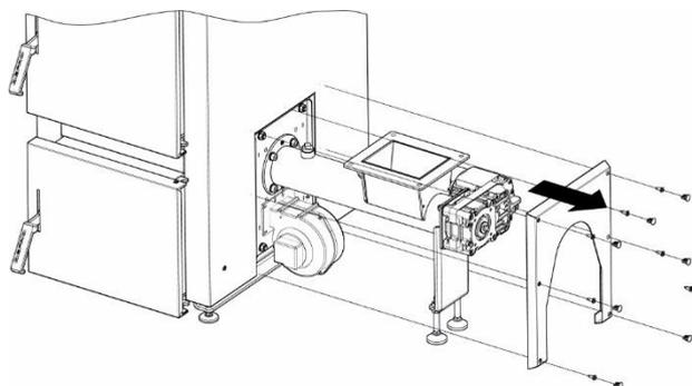
KROK 2. Wypiąć zatrzaski oraz wykręcić wkręty mocujące osłonę palnika, a następnie zdemontować osłonę palnika.
