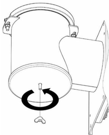
KROK 1. Odkręcić nakrętkę motylkową mocującą dekiel wyczystki palnika retortowego.
