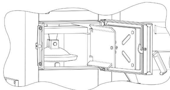
KROK 7. Sprawdzić poprawność montażu panelu ceramicznego – panel powinien być wsunięty, tak, aby z przodu była szeroka szczelina. Następnie zamknąć drzwi odbojnicowe oraz drzwi paleniskowe.
