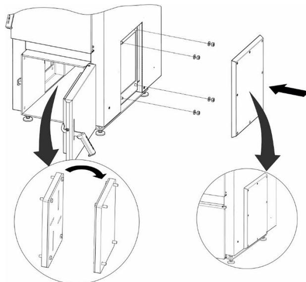
KROK 5. Obrócić płytę o 180°, a następnie zamontować w przeciwnym boku kotła i zamocować za pomocą nakrętek. Następnie zamocować osłonę przyłącza.
