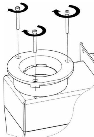
KROK 1. Odkręcić 3 śruby imbusowe M8x75 mocujące płytę palnika retortowego.
