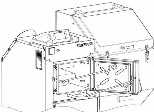
KROK 4. Oczyszczyć powierzchnię wymiany ciepła. Wsunąć zawiórwywacze, zamontować drzwi odbojnicowe i zamknąć szczelnie drzwi kotła
