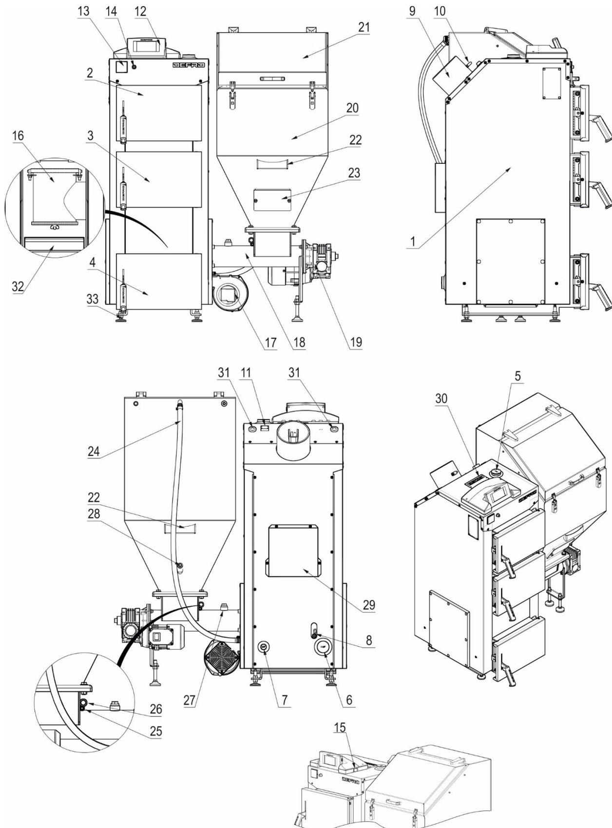
Rysunek 3. Podstawowe elementy kotła KOMFORT EKO MINI.
