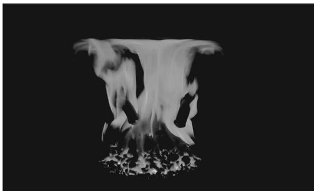
Płomień o białej barwie o porywistym charakterze świadczy o zbyt dużym dopływie powietrza do spalania. W efekcie z paleniska będą wypadały części niespalonego paliwa. Praca palnika ze zbyt dużym dopływem powietrza do spalania znacząco obniża żywotność podzespołu.
