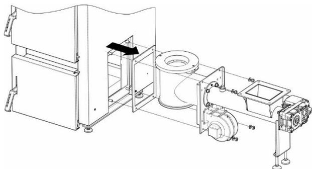
KROK 3. Odkręcić nakrętki mocujące podajnik do korpusu kotła oraz zdemontować uszczelkę. Sprawdzić stan uszczelki, w razie konieczności wymienić.
