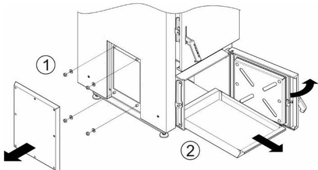
KROK 4. Wypiąć zatrzaski oraz wykręcić wkręty mocujące osłonę przyłącza. Następnie otworzyć drzwi popielnikowe, wysunąć szufladę. Odkręcić nakrętki mocujące przesłonę ceramiczną, uważając aby płyta ceramiczna nie uległa uszkodzeniu.
